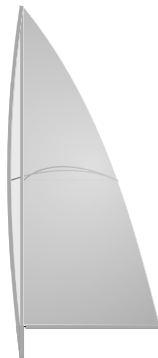
Større mastekrumning flader storsejlet
